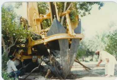
شكل (٢٢-٥) إحاطة الآلة ذات السنت أسلحة بالشجرة ونزولها إلى عمق حوالي ٥١م
