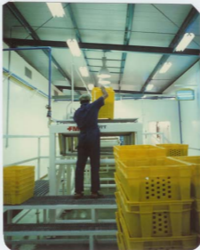
شكل (٤-١٢) إمرار التمر خلال أنفاق ذات تيارات مائية قوية تسلط على التمر من كل الجهات (مصنع تمر العين)
