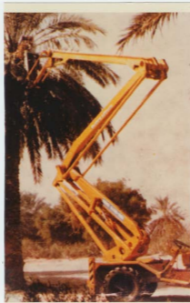
شكل (١١-٤) الأبراج الرافعة والمستخدم في حصاد ثمار نخيل التمر (٩)
