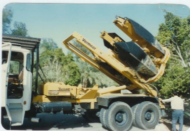
شكل (٢١-٥) آلة هيدروليكية حديثة للتعلم الأشجار الكبيرة مع جذورها
