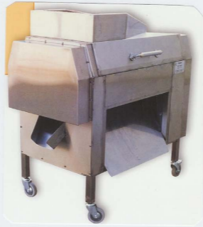
شكل (١٢-٥) جهاز فصل التمر على هيئة عجينة عن البذور (شركة طيبة)
